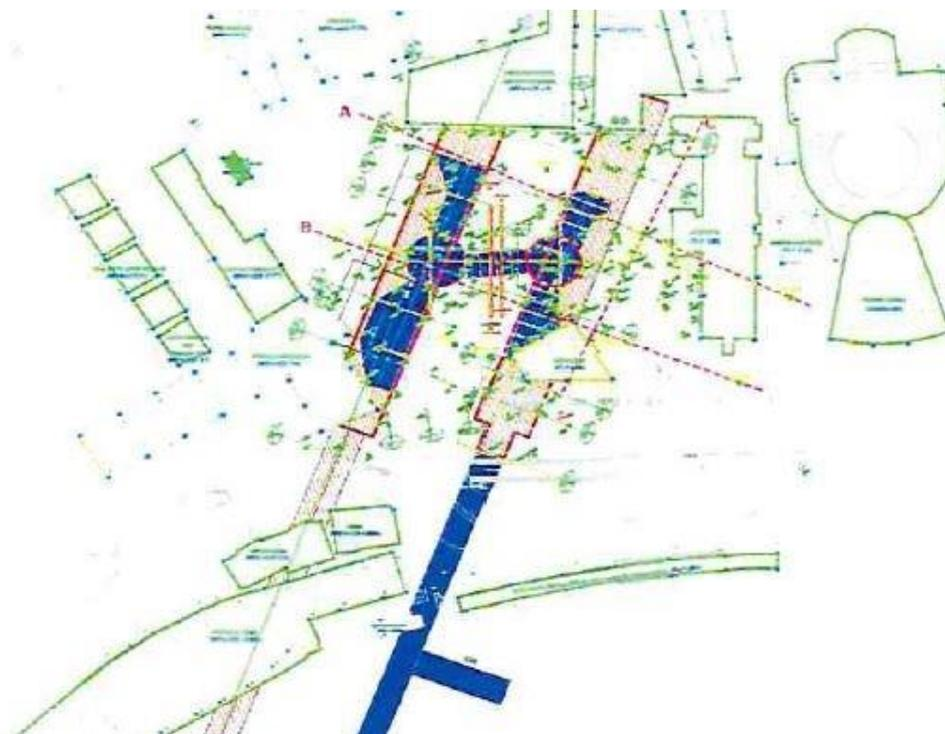
FIGURA 6: Planta da Estação Gávea mostrando as escavações executadas e a executar (reproduzida do **Doc 36 - Riotrilhos**).
